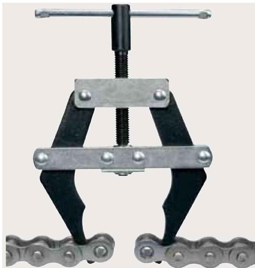
ANTE LA DIFICULTAD QUE PUEDE SURGIR PARA UNIR LOS DOS EXTREMOS DE UNA CADENA, DADO SU LONGITUD O PESO, TENEMOS A NUESTRA DISPOSICIÓN ESTE PRÁCTICO MONTACADENAS, CON EL CUAL, CONSEGUIREMOS ACERCAR LOS DOS EXTREMOS DE LA CADENA, CON UN SENCILLO ROSCADO, QUE NOS PERMITE COLOCAR EL ESLABÓN DE EMPALME CON FACILIDAD.
