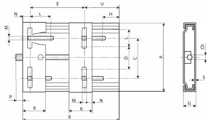
Le slitte tendicinghia per motori elettrici permettono di regolare il tensionamento o lo smontaggio delle cinghie senza rimozione del motore elettrico.
